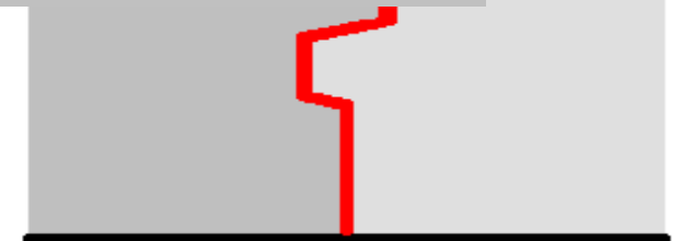
Abbildung 19 Kleberauftrag 2-fach Verzahnung
