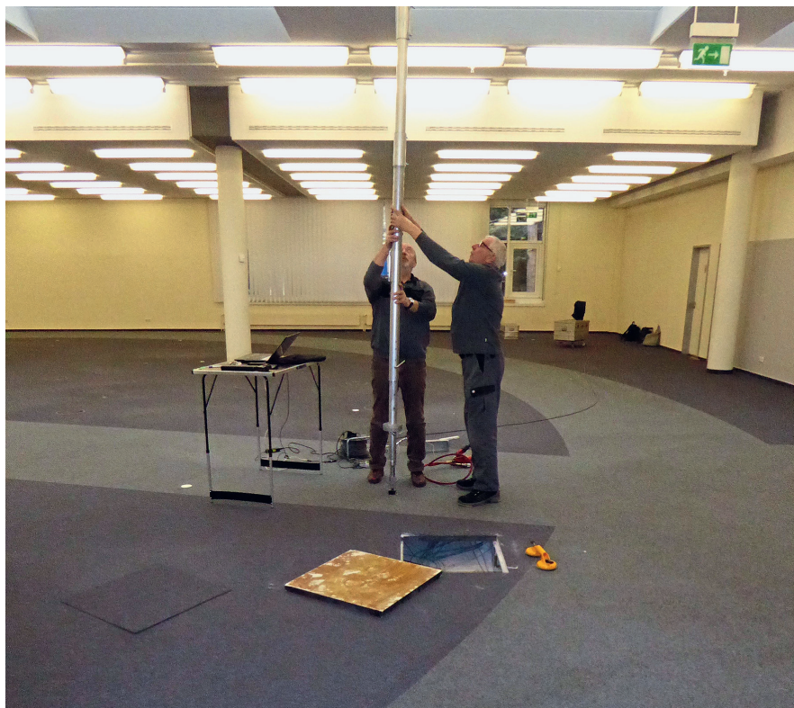
Belastungsprüfung an einer Hohlbodenfläche mit Prüfgestänge.
