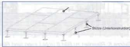
Skizze 3: Beispiel eines Verbund-Doppelbodens im Schema
