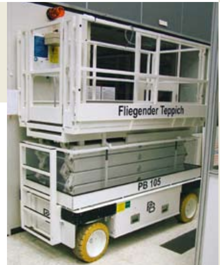
Belastet. Die gefahrlose Belastung mit einem schweren beweglichen Objekt, wie einem Scherenhubwagen, setzt eine korrekte Bemessung des Doppelbodens voraus.
