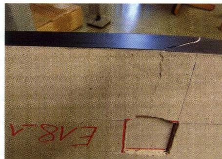
Kein Einzelfall: eine zu hohe Einzellast auf einem Systemboden – ein unverkennbares Schadensbild.
